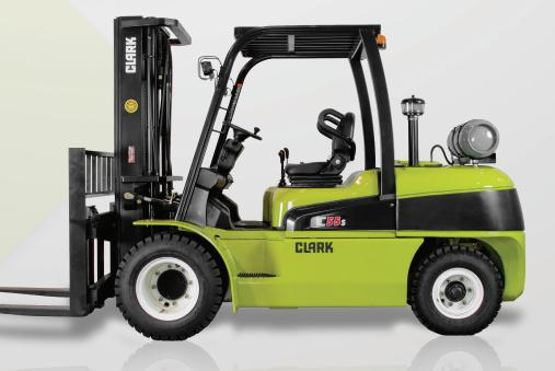
**IC-PNEUMATIC LPG / DIESEL** 4.000 / 4.500 / 4.990 / 5.500 KG
