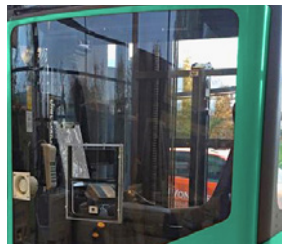
2-vejs samtaleanlæg og rudeåbning til opvarmet kabine
